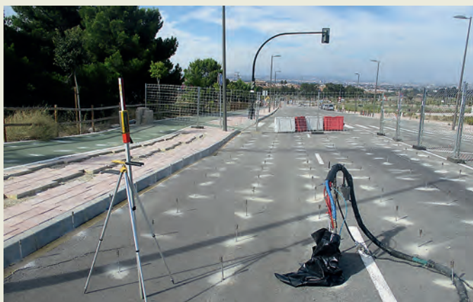
Caracterización del terreno de subbase y fundacional con tomografía de resistividad eléctrica.
