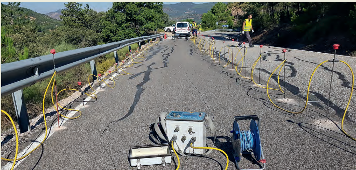
Caracterización del terreno de subbase y fundacional con tomografía de resistividad eléctrica.
