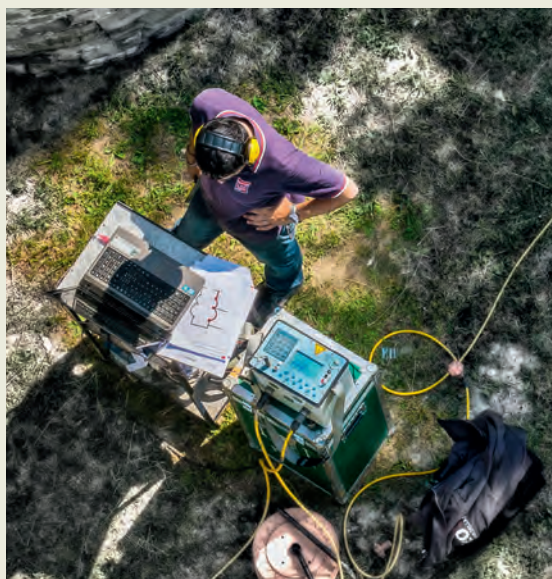
Izquierda, dispositivo para la realización de ERT en obra. Derecha, preparación de dispositivo para ERT sobre lámina de agua. Fuente: archivo GEOSEC®.
