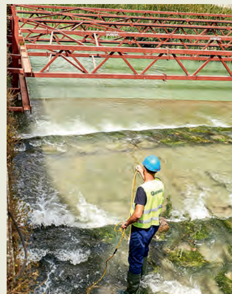
Izquierda, dispositivo para la realización de ERT en obra. Derecha, preparación de dispositivo para ERT sobre lámina de agua. Fuente: archivo GEOSEC®.
