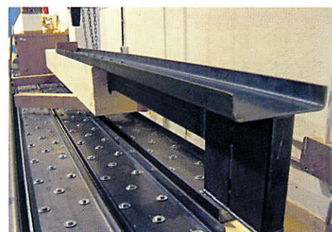
Prótesis de madera con doble pletina inferior.
