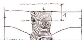
Zona de aplicación de refuerzo sobre el forjado.
