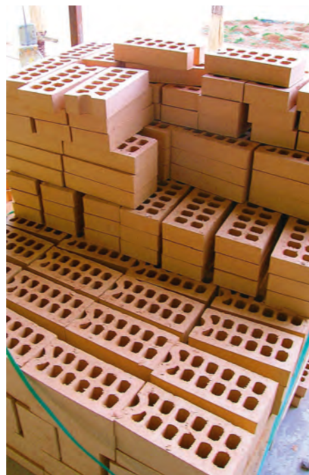
Figura 8: acopio en planta de ladrillos cara vista antes de ser colocados.
