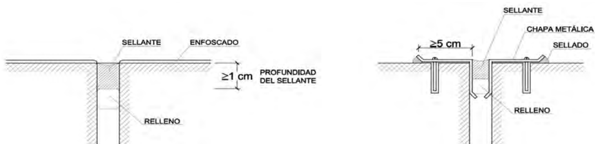
Figura 5: disposición del sellante y el relleno en una junta de dilatación. A la derecha, con una solución mediante chapas conformadas.
