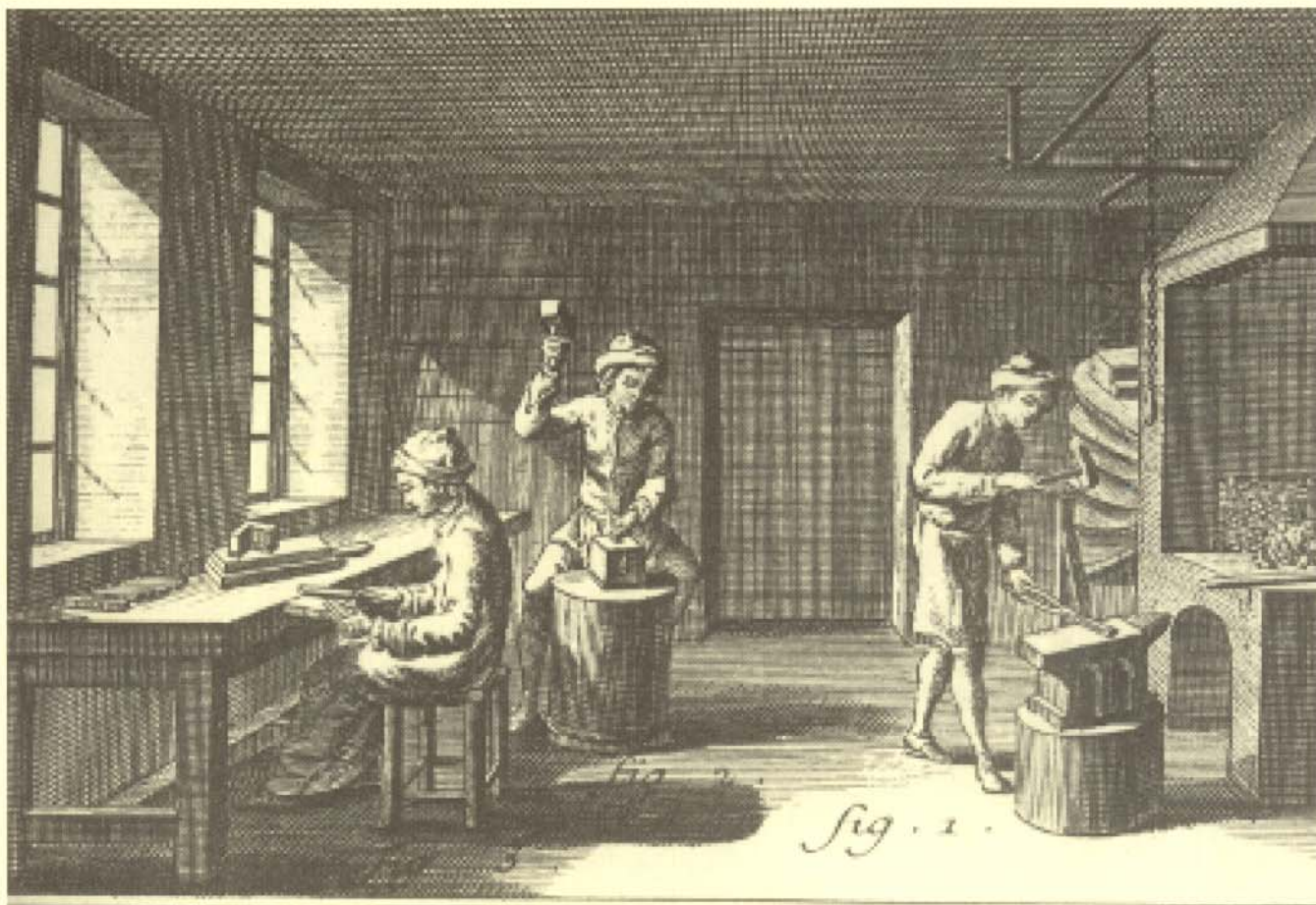
Taller de forja para fabricar letras.
