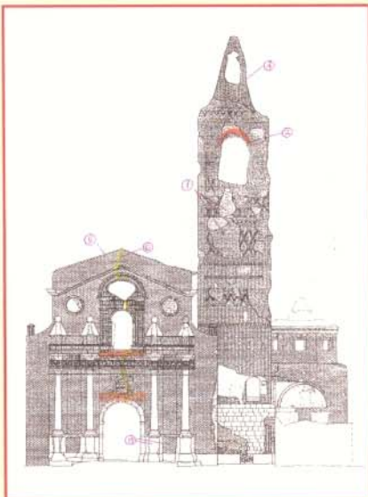
5.- Desaparición de elemento de cubrición. *Limpieza de superficie e imprimación
