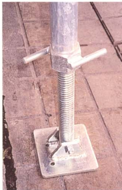
Placa de base en acera.
