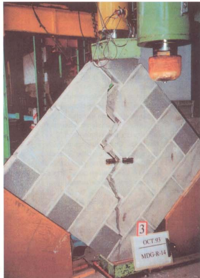
Aspecto de ensayo a compresión diagonal.
