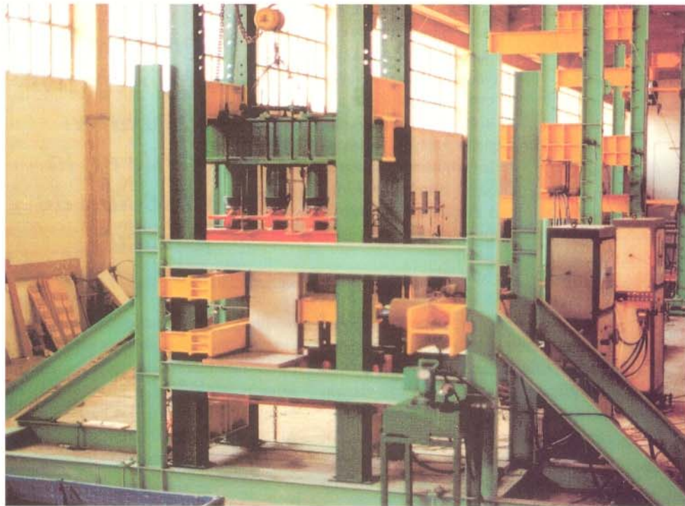
Ensayo de tripletas de bloques de hormigón simples y rellenas, sometidas a corte por cizalle.
