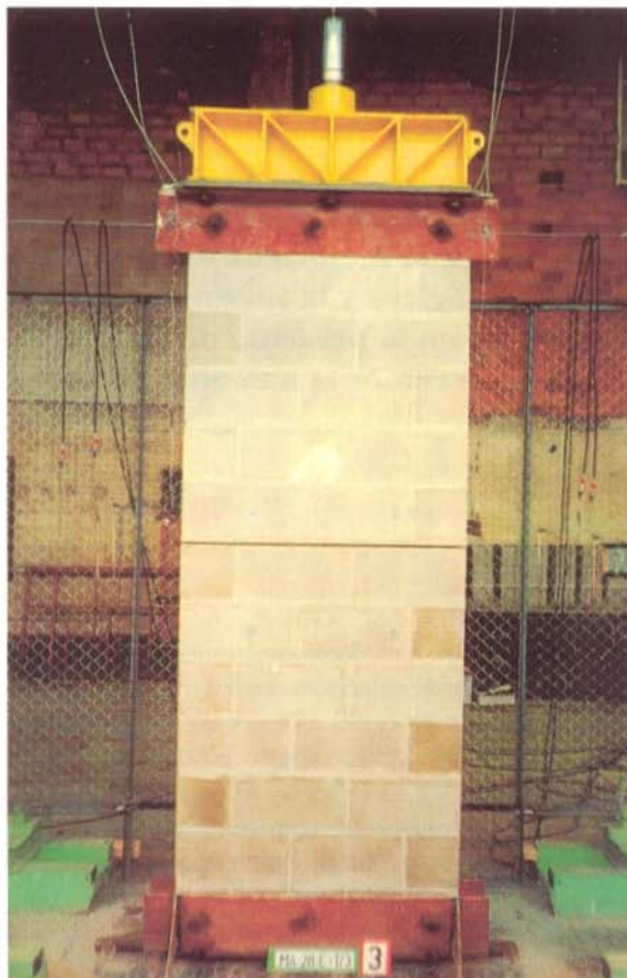
Rotura de muro de bloques de hormigón sometido a flexo-compresión transversal a su plano.
