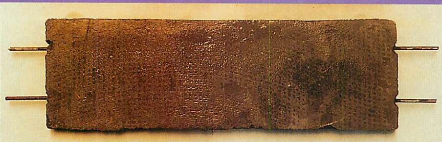
Figura 7. Losa con alambres de acero para pretensar.
