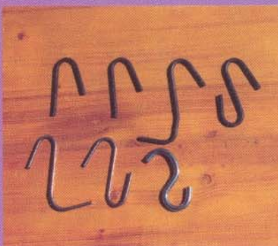
Diversos tipos de ganchos para sujeción de la cuerda perimetral de las redes al puntal (Sistema B).
